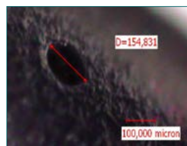
Misure fori di nebulizzazione.
