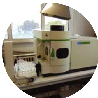
SPETTROFOTOMETRO AD EMISSIONE ICP (PERKIN ELMER)
