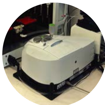
SPETTROFOTOMETRO FT - IR (PERKIN ELMER)
